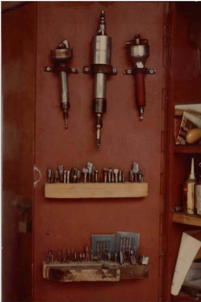
Afbeelding 21: Hennie se gereedschap: Bo: Lugdraaiapparaat. Onder: Draaivyltjies.
